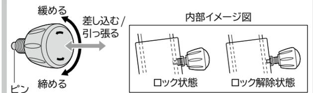
固定ノブは、内部のピンをポストのネジ穴に差し込んで位置決めし、ノブを回してロックします。ピンを差し込んで高さを決めたと後は、必ず固定ノブをロック状態にしてください。
